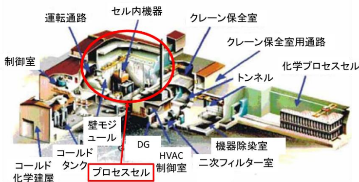
図2 ガラス固化施設(VF)のプロセスセル
