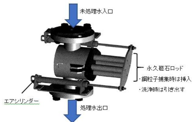
図3 磁気フィルタの例(エアシリンダにより永久磁石が引き出された状態)
